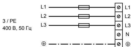
Клеммы подачи электропитания на компрессор 400 В
