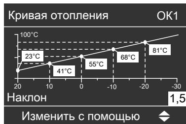
В зависимости от различных значений наружной температуры (изображены по горизонтальной оси) соответствующие заданные значения температуры подачи для отопительного контура изображаются на белом фоне.
