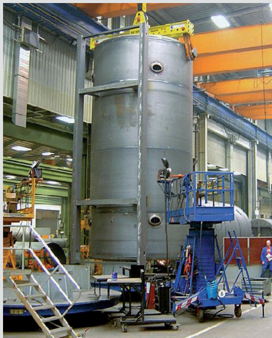
Сварка при оптимальных условиях даже для котла длиной больше 7 метров.
