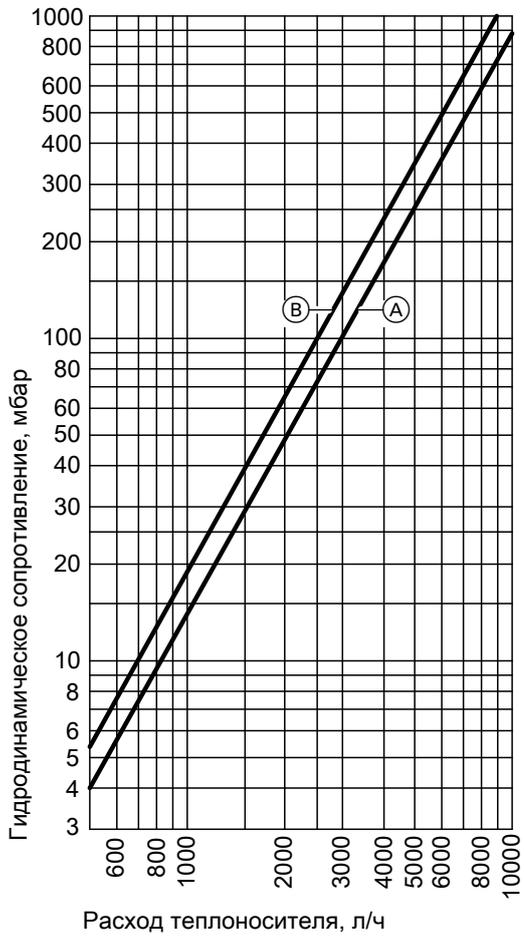
Гидродинамическое сопротивление на стороне контура водоразбора ГВС
